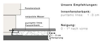
Ab **8 cm Vorsprung** bzw. mehr als **1/3 der Ausladung** sind die Fensterbänke zusätzlich mit Stützwinkel zu befestigen. Abstand max. 50 cm.
