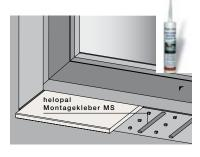
Die puritamo linea Fensterbank mittels dauerelastischem Kleber (helopal Montagekleber MS) auf das vorgerichtete Mauerwerk kleben. Den Kleber raupenförmig quer zur Längsrichtung im Abstand von ca. 10 cm auftragen. Raupenhöhe ca. 5-8 mm. Kleberstärke ausgehärtet 3 bis max. 6 mm.
